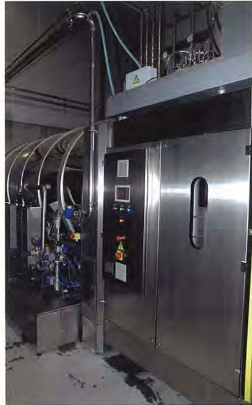
Die Waschstraße Vario 16 x 60 Kilogramm von Black & White wurde im Sommer 2009 installiert. Mit der neuen Waschstraße konnte man bei Busch Textilservice einen weiteren Abschnitt der Wärmerückgewinnung verwirklichen. Beide Waschstraßen, auch die ältere Senking P 18-13, sind mit Wärmetauschern ausgestattet.
