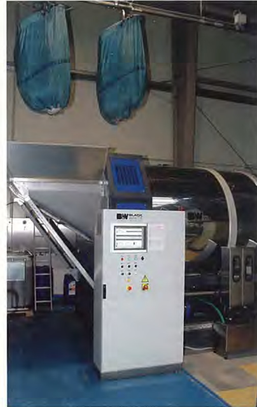
Die Waschstraße Vario 16 x 60 Kilogramm von Black & White wurde im Sommer 2009 installiert. Mit der neuen Waschstraße konnte man bei Busch Textilservice einen weiteren Abschnitt der Wärmerückgewinnung verwirklichen. Beide Waschstraßen, auch die ältere Senking P 18-13, sind mit Wärmetauschern ausgestattet.
